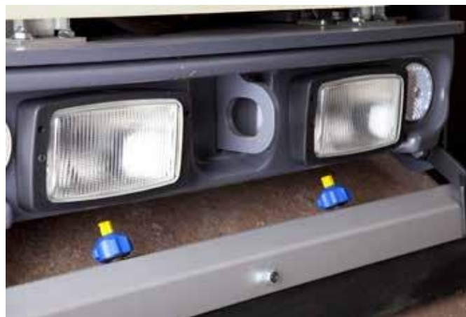
Sistema de riego presurizado con una potente bomba de agua con tubos y boquillas con auto-drenaje.
