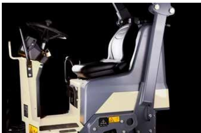
Una amplia plataforma de operador aislada de vibraciones con palancas de marcha delante /atras para un confort total del operado
